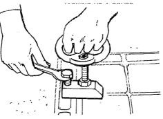
TIGHTENING THE JACKING SCREW
